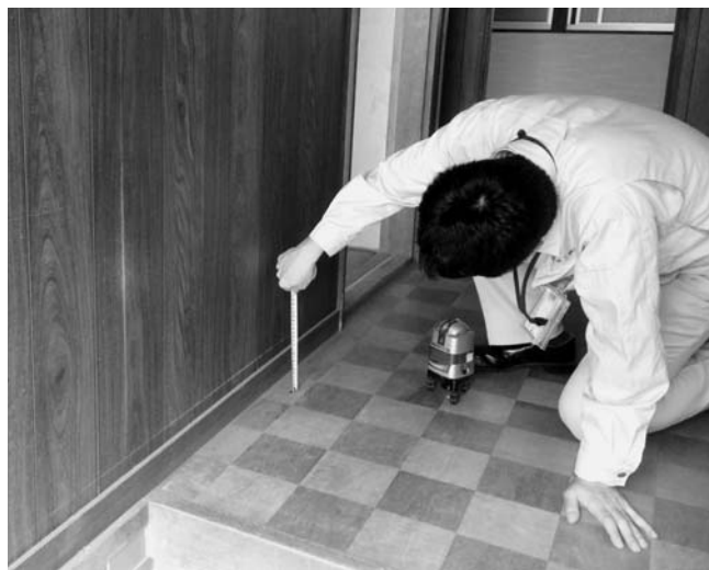
専門器具を用いたインスペクション実施の様子
